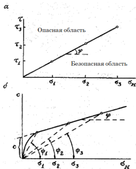
Рис. 10.10. Диаграмма сопротивления сдвигу песчаных (а) и глинистых (б) пород (с – сцепление пород)
