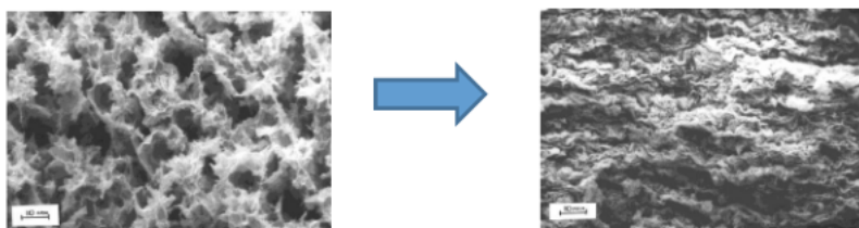
Рис. 10.4. Изменение ориентации частиц монтмориллонитовой глины при уплотнении
