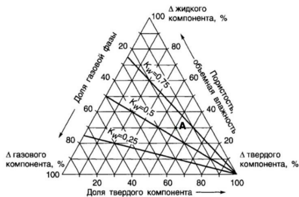
Рис. 5.11. Диаграмма фазового состава грунта с нанесенными значениями коэффициента (степени) влажности K_w A – реальное соотношение в грунте всех трех фаз
