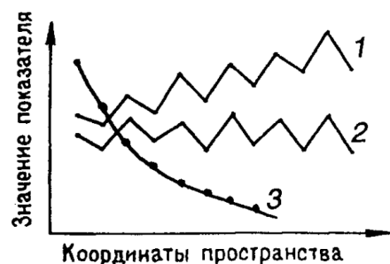
Рисунок 18.3. Режим инженерно-геологической изменчивости грунтов: нестационарная скачкообразная зависимость (1), стационарная (скачкообразная) зависимость (2), квазифункциональная
