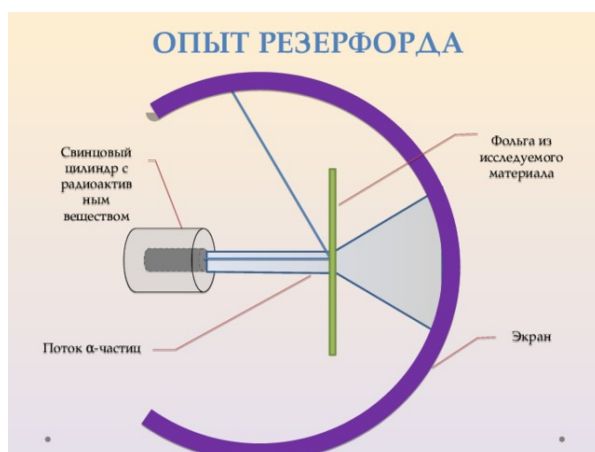
Рис. 4. Схема опыта Резерфорда
