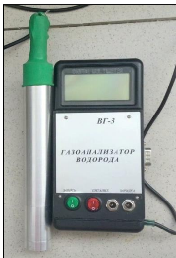
Рис. 4.22. Инструментальной основой для полевых исследований является портативный газоанализатор водорода ВГ-3, разработанный на кафедре физики твердого тела и наносистем Национального исследовательского ядерного университета «МИФИ» под руководством профессора И.Н.Николаева
