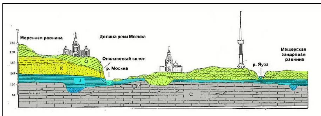
Рис. 3.4. Схематический геологический разрез верхней части осадочного чехла г. Москвы (Москва. Геология и город, 1997)
