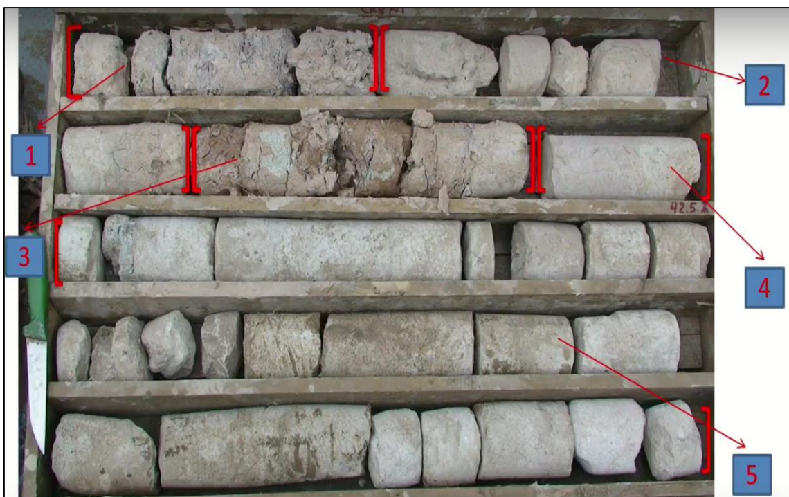
Рис. 3.11. Керн скважины 1, расположенной по адресу: г.Москва, ЗАО. Интервал 40-45 м. Фото Р.Р. Габдуллина. 1-глина розовато-коричневая с зеленоватыми пятнами оглеения, керн сильно разрушен. 2-известняк зеленовато-серый, слабо глинистый. 3-глина сиренево-красная, доломитизирована, с зелеными пятнами оглеения. 4-доломит глинистый фиолетово-серый, внизу-зеленоватый, 5-известняк светло-серый, мелкозернистый
