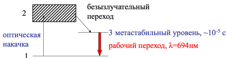
Рис. 15.8. Получение инверсной заселенности с помощью трехуровневой схемы для лазера на рубине.
