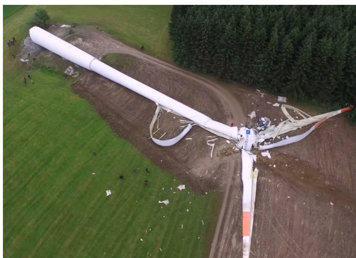
Рис. 1.13 Падение ветряной установки вследствие шквального ветра
