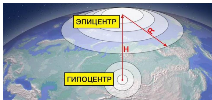
Рис.4.2. Гипоцентр и эпицентр землетрясения: R - расстояние до эпицентра, H - глубина очага землетрясения
