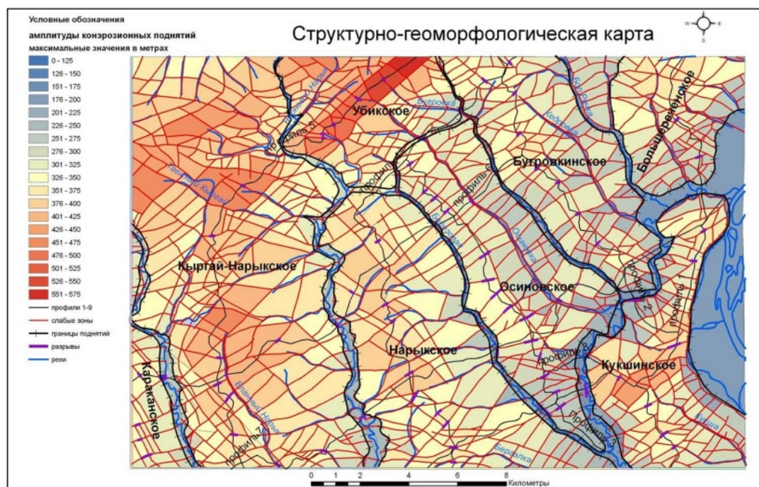
Рис. 12.6. Структурно-геоморфологическая карта одного из районов Кузнецкой впадины (Панина, 2008). На карте видны новейшие поднятия, которые оконтуриваются узкими долинами-впадинами (голубой цвет). Поднятия разбиты слабыми зонами или линеаментами (красные линии) на разновысотные блоки рельефа (оттенки красного и голубого цвета). Отчетливо проявляется северо-восточное простираие слабых зон, в меньшей степени развиты северо-западные слабые зоны.
