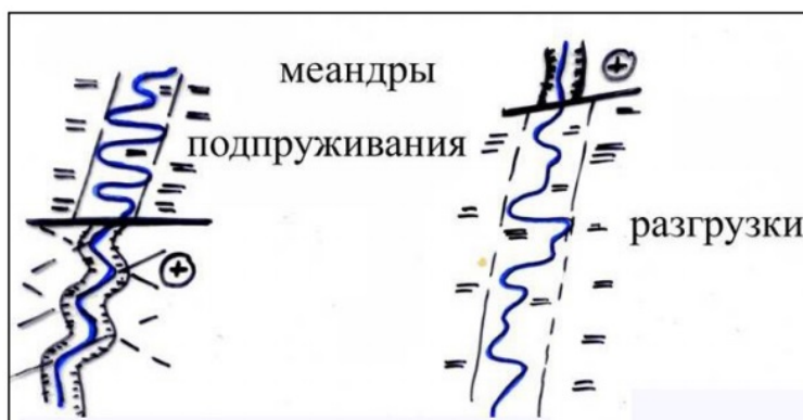
Рис. 12.3. Изменения типов меандр при пересечении рекой развивающегося поднятия
