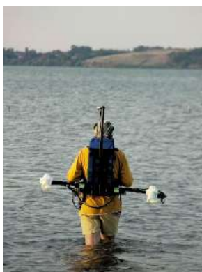
Рис. 3.8. Морская магнитная съемка
