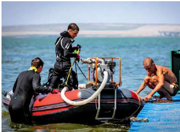
Рис. 3.18. Подготовка лодки с помпой для грунтососа
