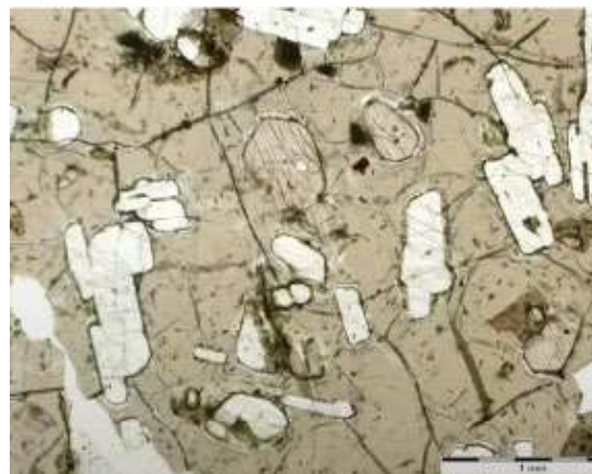
Рис. 4.8. Базальт под микроскопом (в шлифе)
