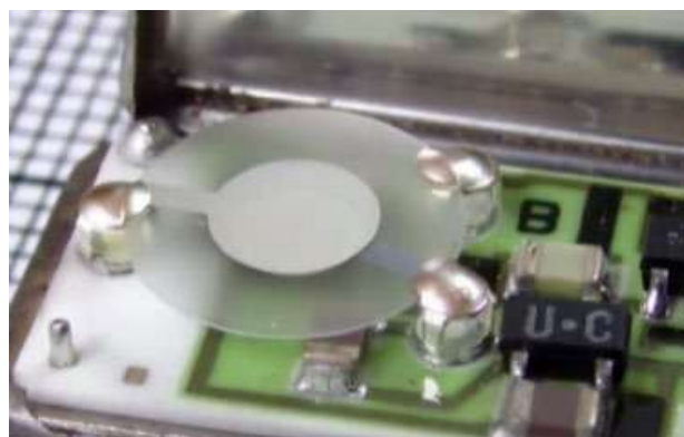
Рис. 2.84. Кварцевая пластина в резонаторе
