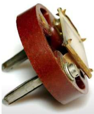
Рис. 2.89. Кварцевый резонатор. Середина 20 века
