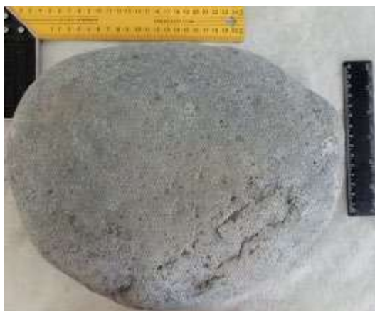
Рис. 3.24. Валунь каркаса размером до 40-45 см. Более мелкие камни заполнения размером 10-15 см
