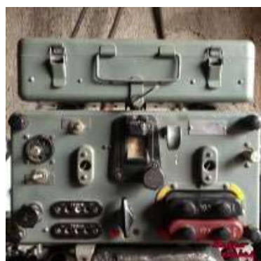
Рис. 2.88. Радиопередатчик с двумя кварцевыми резонаторами
