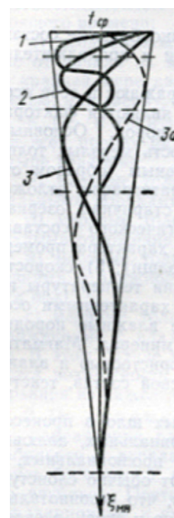
Рис. 5.8. Затухание амплитуд с глубиной в зависимости от Тм.н.: 1 – 10 лет; 2 – 40 лет; 3 – 300 лет; 3а – смещение фаз – максимумов и минимумов – в глубину за четверть периода
