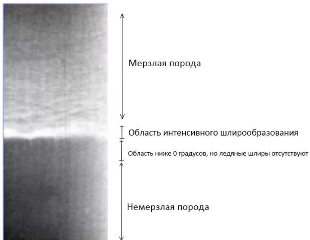
Рис.7 Процесс промерзания образца.
