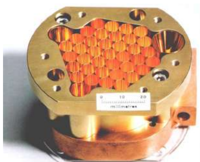
Рис.12.8. Матрица, используемая при детектировании радиоволн малой длины.
