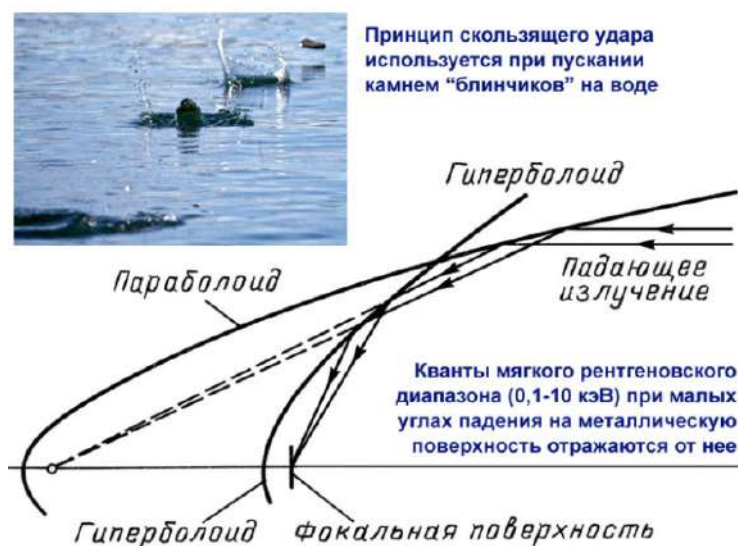
Рис. 13.10. Принцип отражения рентгеновских лучей.
