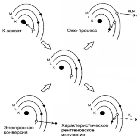
Рис. 2.5 Процессы, приводящие к возникновению электронной вакансии, и пути её ликвидации.
