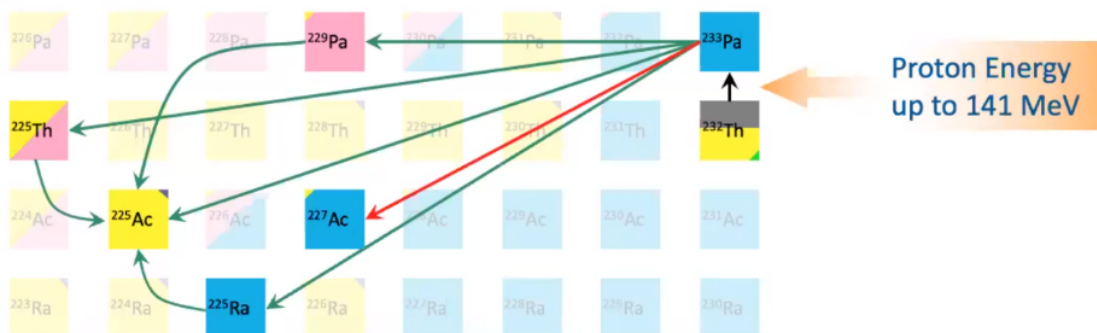
Рис. 11. 8 Основные ядерные реакции, протекающие при облучении ^{232}\text{Th} протонами, приводящие к образованию ^{225}\text{Ac} и ^{227}\text{Ac} .
