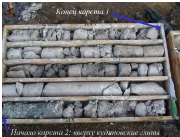
Рис. 6.21. Керн. Карбонатный разрез, (ул. Зорге, вл. 9)
