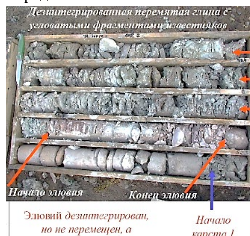
Рис. 6.20. Керн. Карбонатный разрез, (ул. Зорге, вл. 9)
