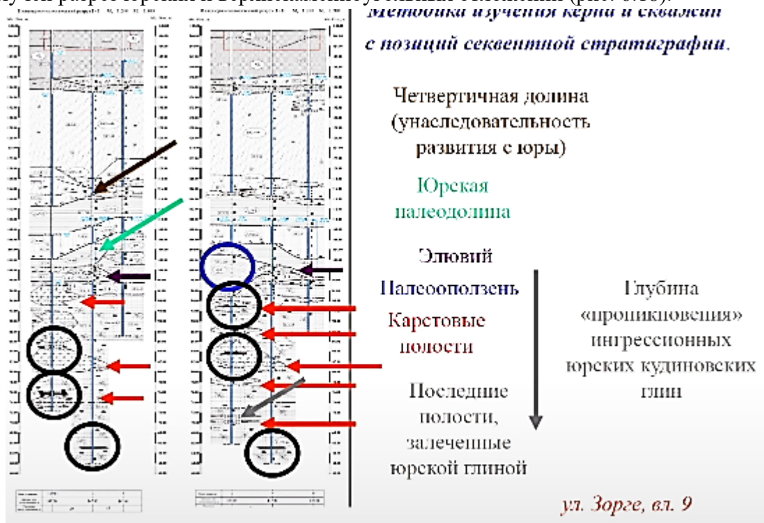
Рис. 6.18. Геологический разрез по адресу: ул. Зорге, вл. 9
