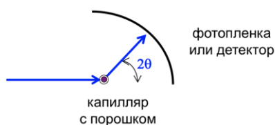
Рисунок. 5.12. Геометрия съемки в РФА.
