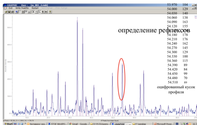
Рисунок. 6.1. Обработка дифрактограммы в РФА.
