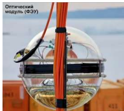
Рис. 23.30. Байкальский глубоководный нейтринный телескоп. Оптический модуль (ФЭУ)
