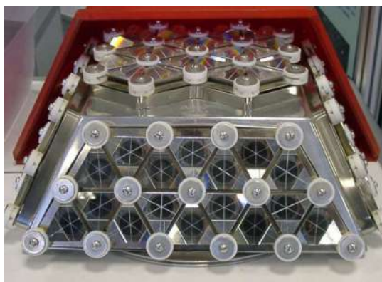
Рис. 9.6. Трехгранные призмы рефлектора
