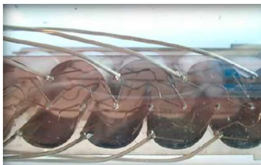
Рис. 5.16. Умножительная система ФЭУ
