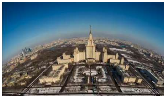
Рис. 3.25. Бочкообразная дисторсия на фото с широкоугольным объективом «рыбий глаз»
