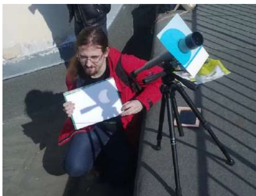
Рис. 24.5. Изображение на экране луча света, пропущенного через телескоп
