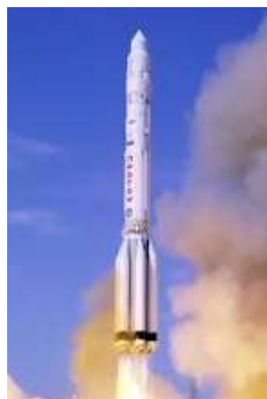
Рис. 15.10. Ракета-носитель «Протон» (Россия) 705 т. Масса спутника на ГСО 3.7 т
