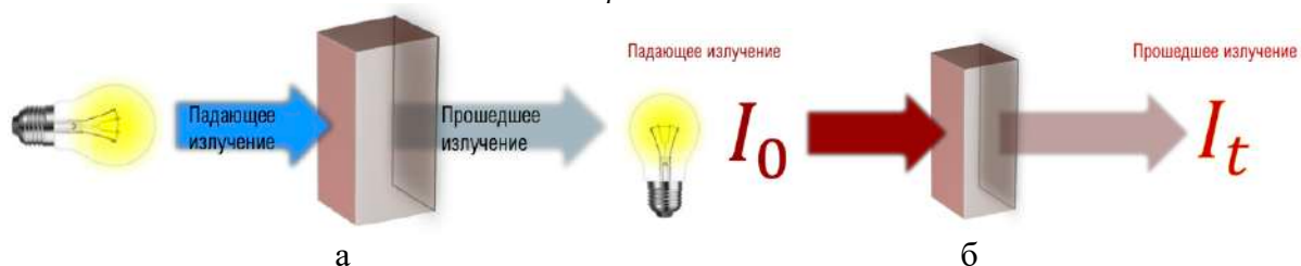
Рис. 13.7. Сигналы в молекулярной спектроскопии (а) и закон Бера (б).
