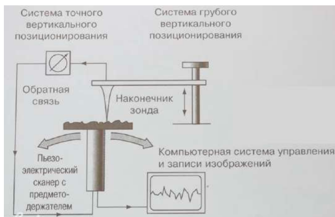
Рис. 7.14. Сканирующая туннельная микроскопия: изображение на атомной уровне без оптики.
