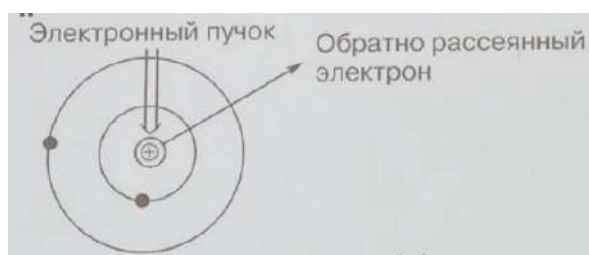
Рис. 7.7. Обратное рассеяние на ядре. Интенсивность \sim N , контрастны тяжелые элементы (а), неупругое рассеяние на электронной оболочке.
