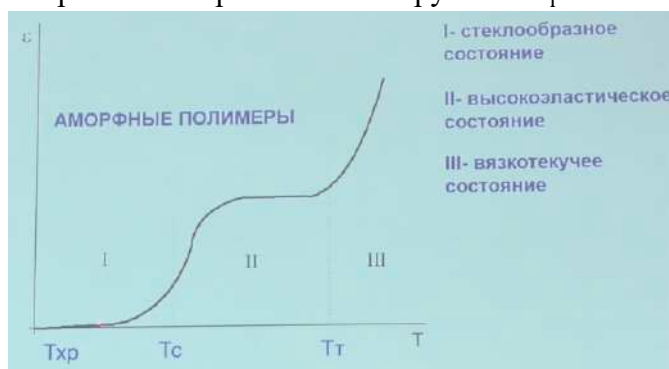
Рис. 16.20. Деформации вещества при изменении температуры (термомеханический метод испытания полимеров).
