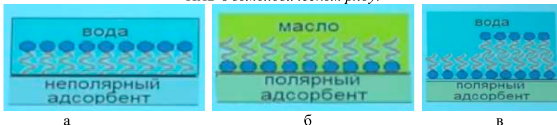
Рис. 24.20. Адсорбция на границе раздела твердое тело-жидкость: а – хорошо адсорбирует ПАВ из полярной среды, б – хорошо адсорбирует ПАВ из неполярной среды, в – при хемосорбции (адсорбции за счет образования химических связей с поверхностью) правило Ребиндера не соблюдается. Однако при высоких концентрациях ПАВ образуется второй слой (аналогично случаю а) в соответствии с правилом Ребиндера.
