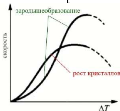
Рис. 4.18. Скорости зародышеобразования и роста кристалла в зависимости от пересыщения.
