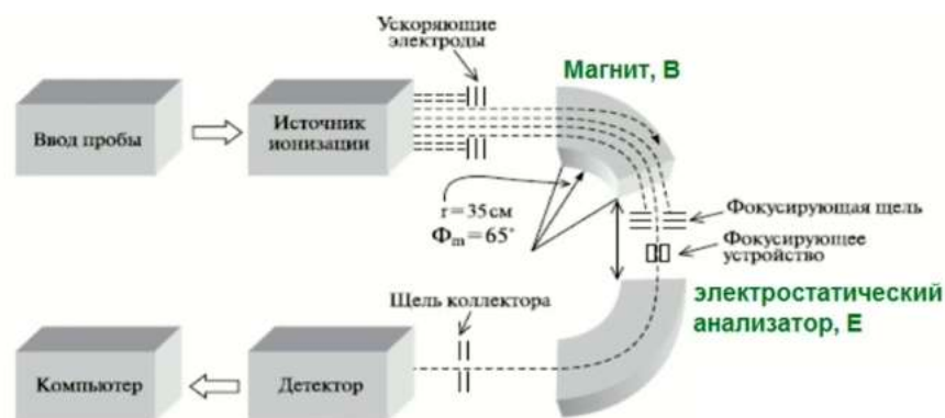
Рис. 18.2. Схема масс-спектрометра с двойной фокусировкой.
