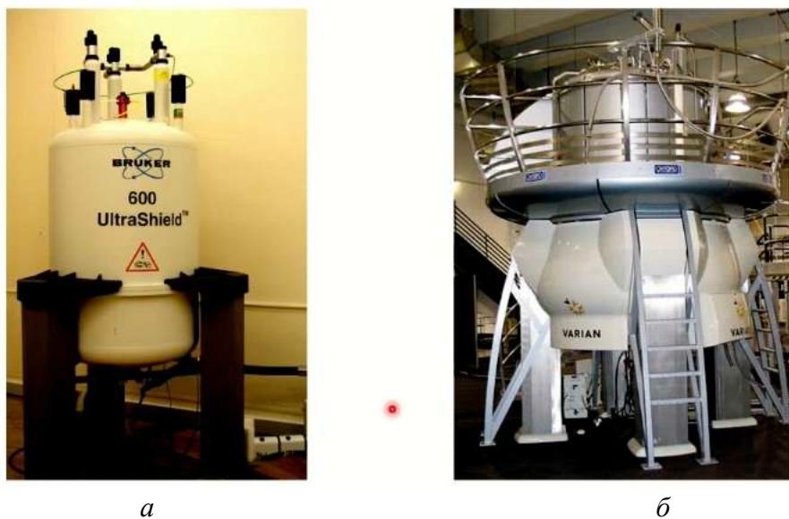
Рис. 18.12. Современные спектрометры ЯМР: магнит спектрометра Bunker AVANCE 600 МГц в Центре магнитной томографии и спектроскопии МГУ (а), магнит спектрометра Varian 900 МГц (б).
