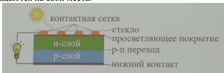
Рис. 5.8. Суть полупроводникового солнечного элемента.
