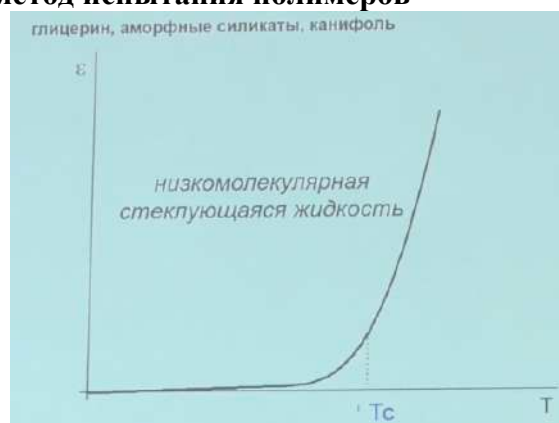
Рис. 16.19. Деформации вещества при изменении температуры.
