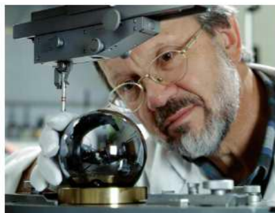
Рис. 11.4. Avogadro project: идеальный шар из чистого кремния массой 1 кг.
