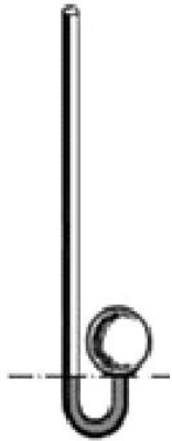
Термоскоп Галилея (1592 г.)
