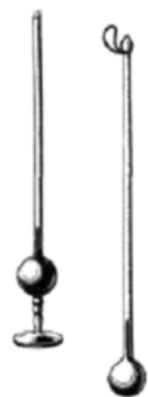
Жидкостный термометр Торричелли (1631 Г.)
