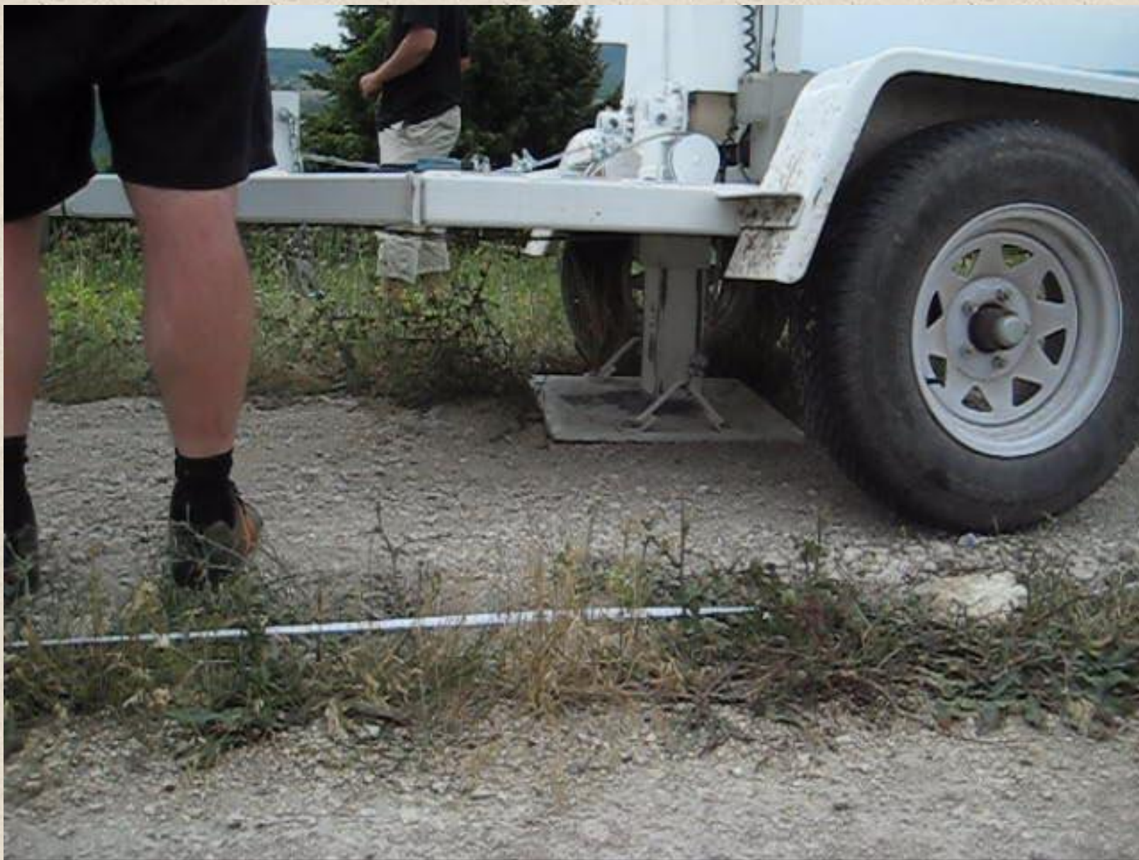
Возбуждение упругих волн с помощью специализированного сейсмического источника ESS200.
