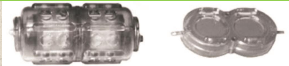
Пьезоприемник ПДС-21 (слева), реагирующий на сжатие пьезокерамических цилиндров и ПДС-7 (справа), реагирующий на изгиб пьезокерамических пластин.
