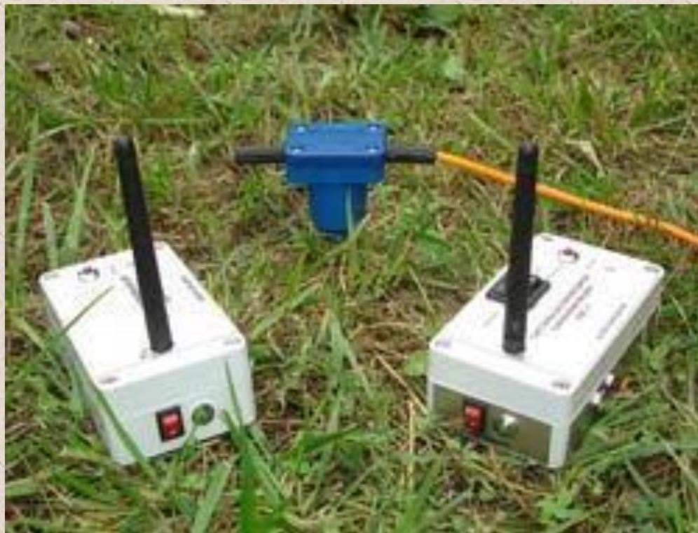
Система беспроводной синхронизации «по обнаружению» с помощью геофона.
