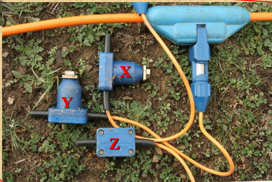
Геофоны, установленные на ПП, для регистрации P , SV и SH волн.
