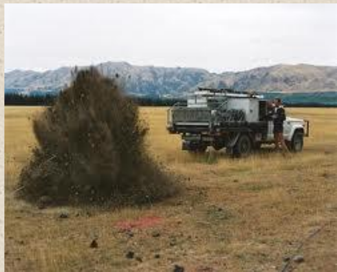
Взрывы ВВ при возбуждении упругих волн.
