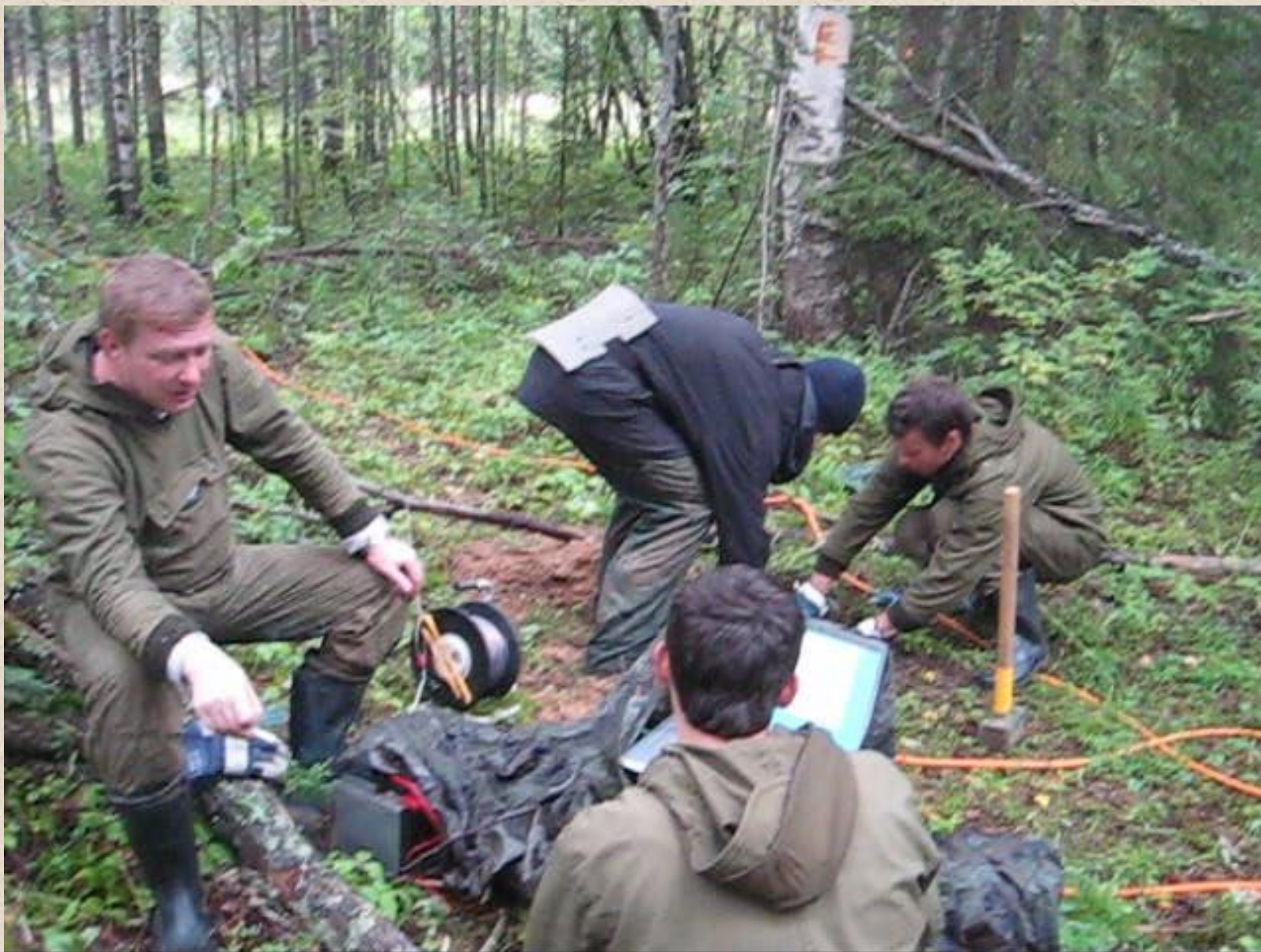
Возбуждение поперечных волн с помощью кувалды.
