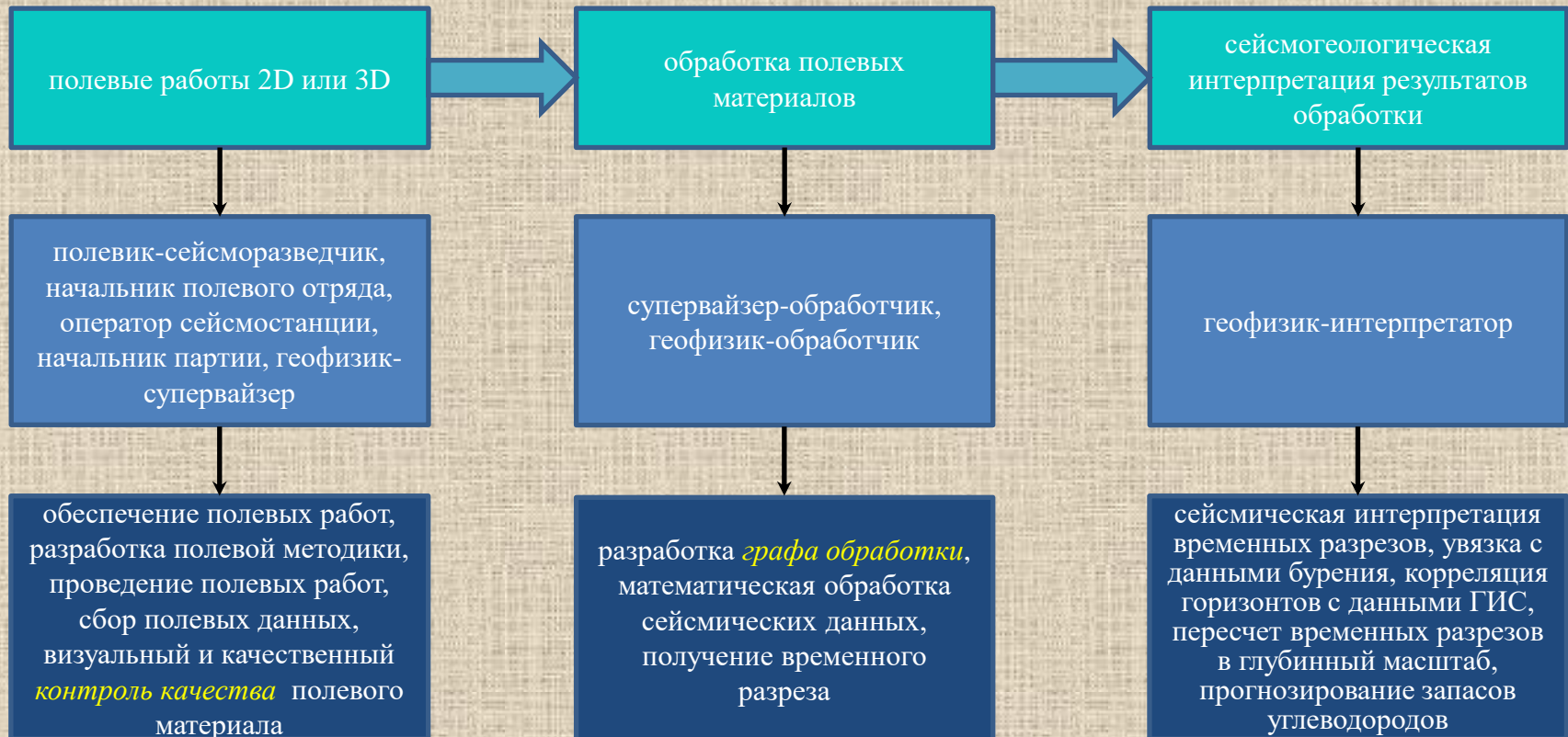
Стадии сейсморазведочного процесса в МОБ.
