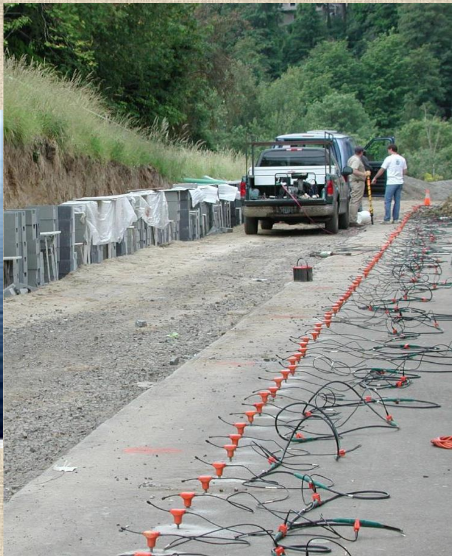
Многоканальные наземные сейсмические исследования при малоглубинной сейсморазведке.
