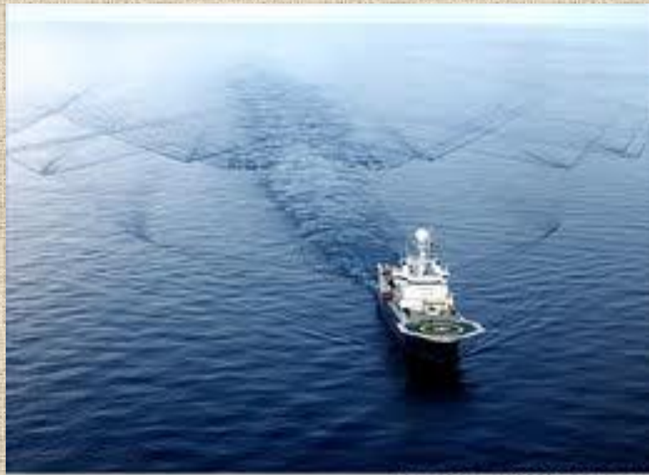
Многоканальные морские сейсмические исследования с помощью специализированного судна.
