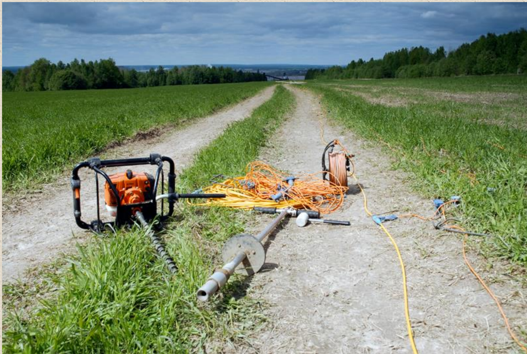
Возбуждение упругих волн с помощью пороховой пушки.
