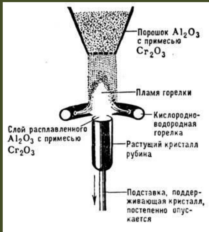
Схема синтеза по методу Вернейля
