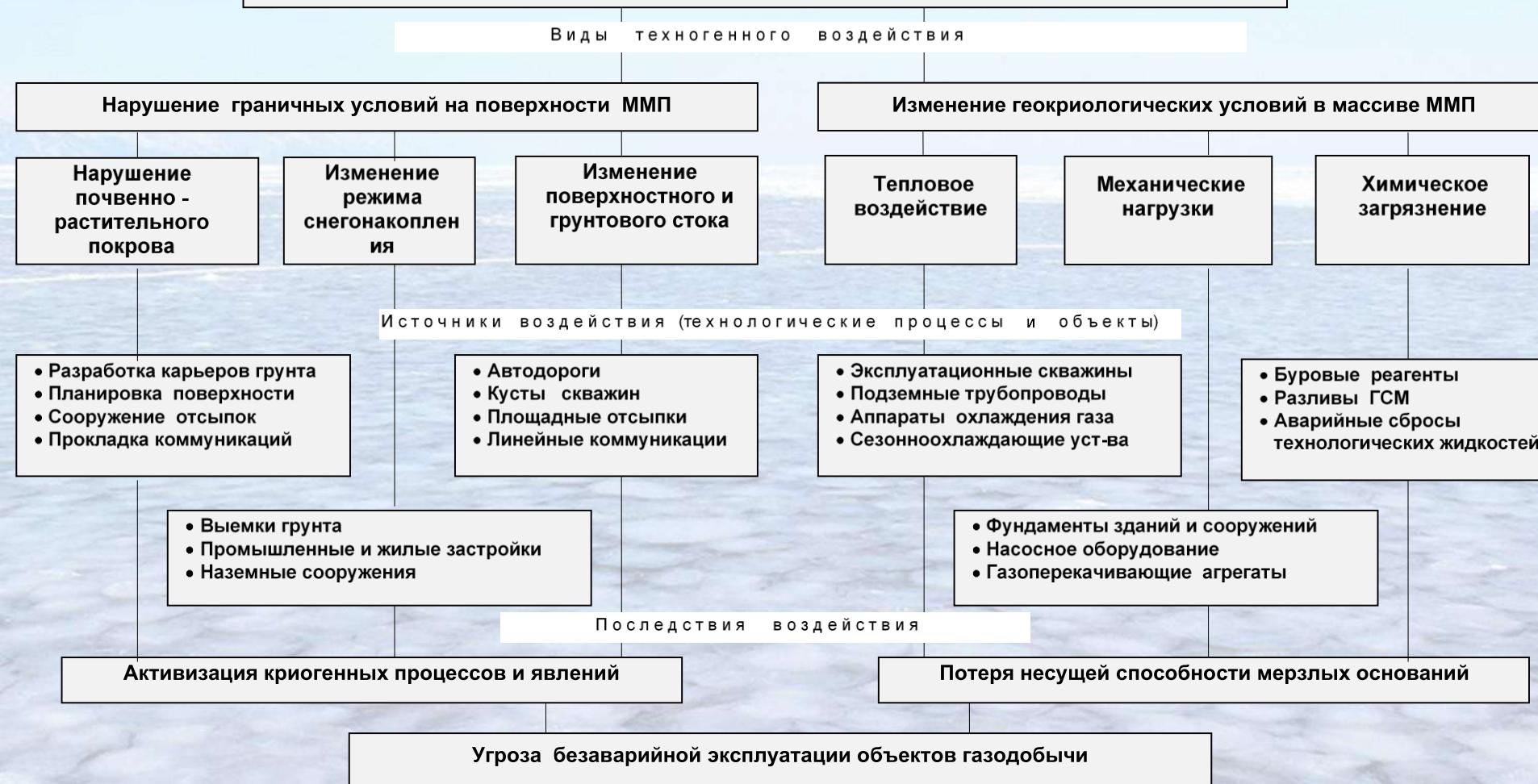
Рис. 4.3.1. Типизация техногенных воздействий объектов нефтегазовой промышленности на ММП.
