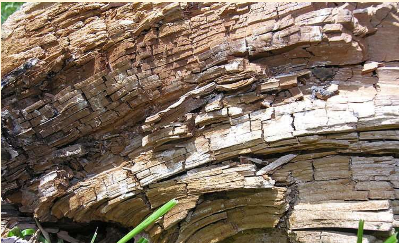
Бурая («сухая») гниль древесины ( Fomitopsis sp. и др. грибы)
